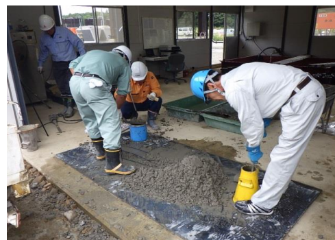
コンクリートの試し練り
